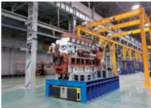
На «Пензадизельмаше» (входит в состав АО «Трансмашхолдинг») начала работу эталонная линия по сборке дизель-генераторов 1-ПДГД. Они используются в конструкции маневровых тепловозов Брянского машиностроительного завода.
