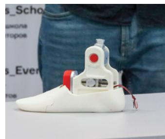
В отличие от традиционных, прототип протеза ноги содержит 12 датчиков, которые преобразуют движение в сигналы, воссоздающие ощущение прикосновения к стопе пользователя. Также решена проблема с неправильным распределением веса, механизм обеспечивает обратную тактильную связь, тем самым оповещая человека о дальнейшем автоматическом исправлении положения конечности с помощью вибрации.
