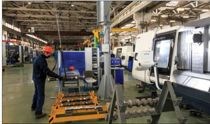
предназначенных для изготовления ключевых компонентов двигателей. Это токарный станок с числовым программным управлением для цеха дизельного производства, в механо-гальваническом цехе запустили два станка с ЧПУ, два токарно-фрезерных обрабатывающих центра, а также два фрезерных обрабатывающих центра НЕС 800.
