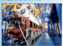
Заводской ремонт первого дизельгенератора, эксплуатируемого на маневровом тепловозе более десяти лет, пройдет в четыре этапа. Сначала осуществляется приемка и осмотр двигателя, затем разборка и дефектация узлов и деталей, далее ремонт и изготовление компонентов. На финише проводится сборка, испытания и передача отремонтированного генератора заказчику.
